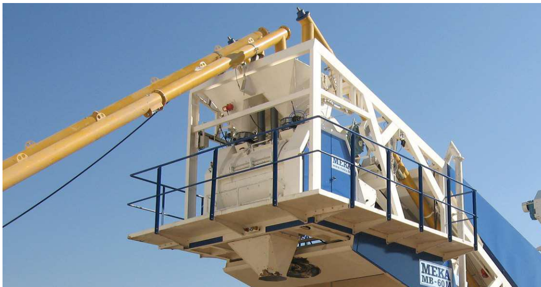
Slika 5.7. Opšti izgled mješalice za proizvodnju betona „MIXSER MB – S“
