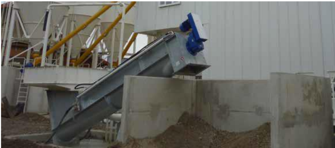
Slika 5.9. Uređaj za izdvajanje kamenih agregata iz reciklirane (prečišćene) zaprljane vode
