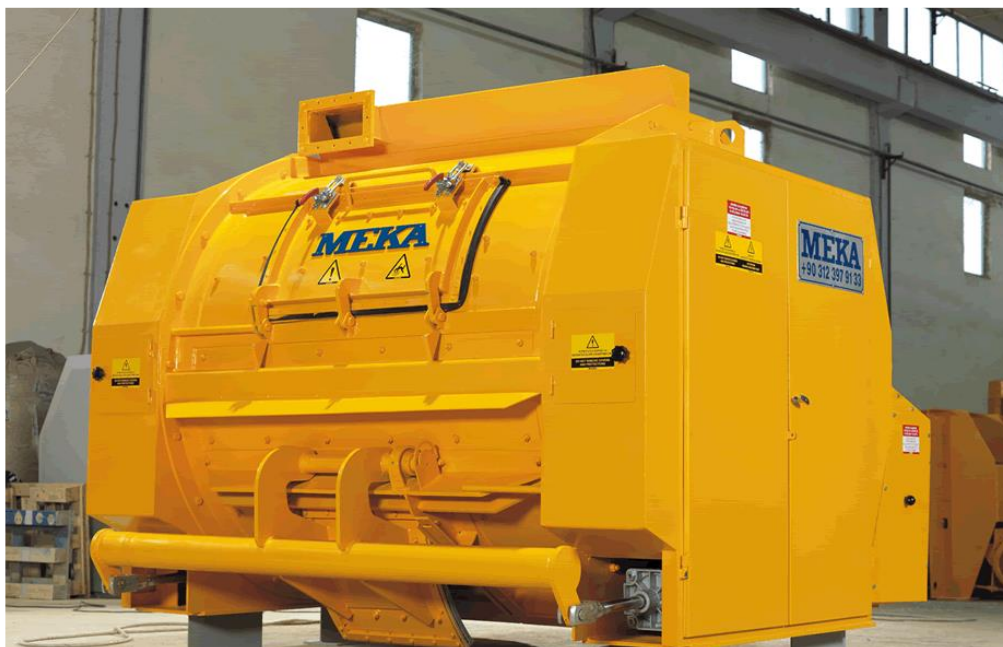
Slika 5.5. Opšti izgled mješalice za proizvodnju betona „MIXSER MB - S“ zapremine V = 1,0 \text{ m}^3
