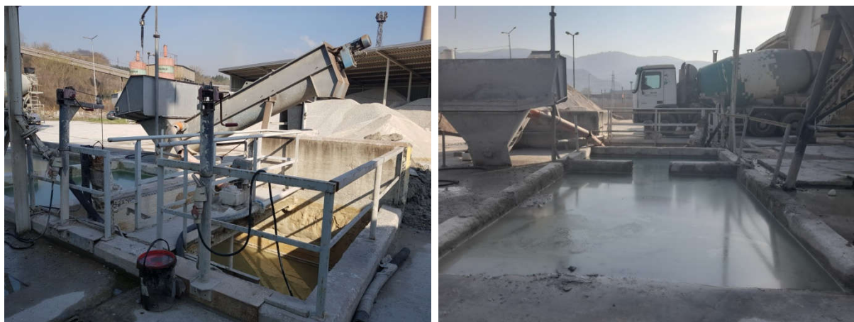
Slika 8. Sabirni bazen (sa mješalicom) za prihvrat prečišćenih otpadnih voda na betonari
