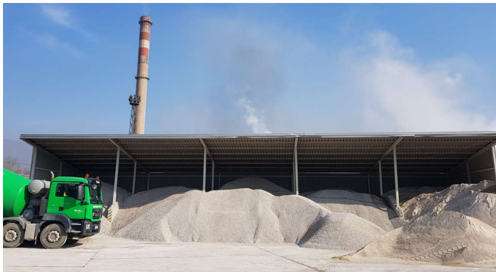
Slika 5. Skladište kamenih agregata na sjevernoj strani betonare sa 5 odjeljaka
