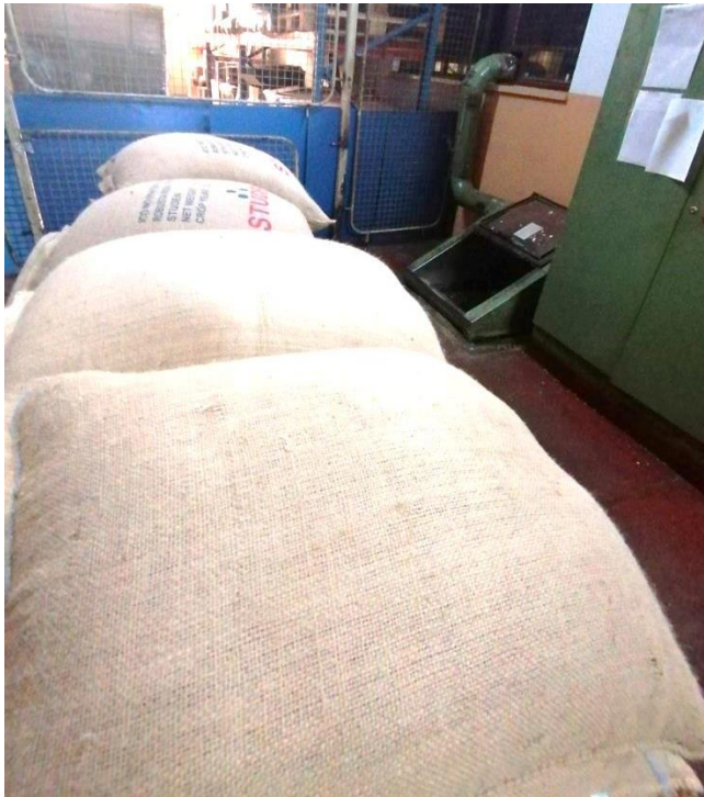
Ubacivanje kafe u čistionicu iz skladišta sirovina
