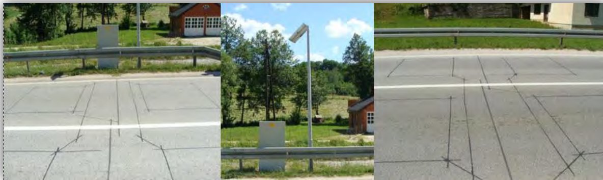
Slika 1.2.2. Automatski brojač prometa sa induktivnom petljom
