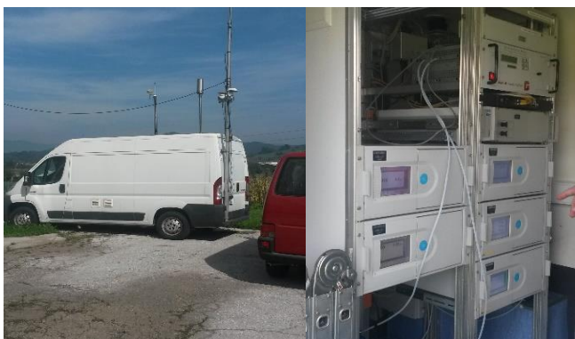
Slika 14. Mobilna automatska stanica za monitoring kvaliteta zraka
